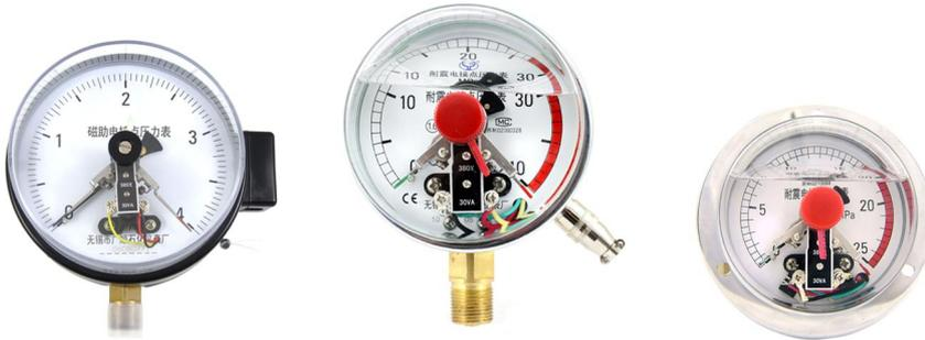
YXC 系列磁助式电接点压力表采用了磁力作用的电接点装置，具有额定功率大、发信可靠、接点寿命长等优点，有一定的抗介质脉动和环境振动性能。
